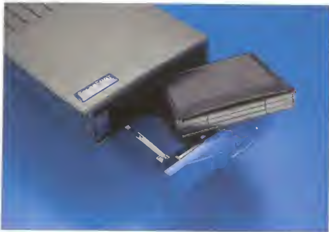
La carga de papel es totalmente novedosa: éste va dentro de un cartucho que se inserta en la impresora.
